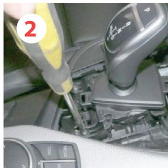
**2** Originale Schrauben lösen und ersetzen durch ...
